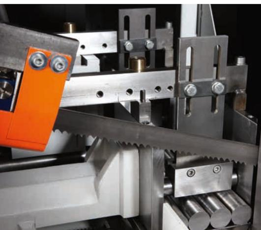
Dispositif hydraulique de serrage intégral pour coupes en paquet, côté aval.
